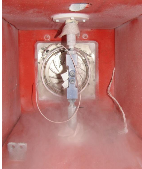
Bruchmechanikversuch: CT-Probe bei -140^{\circ}\text{C}
