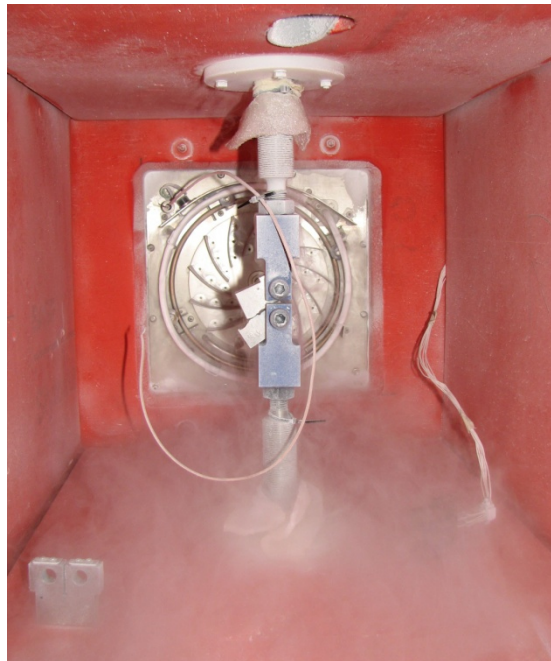
Bruchmechanikversuch: CT-Probe bei -140^{\circ}\text{C}
