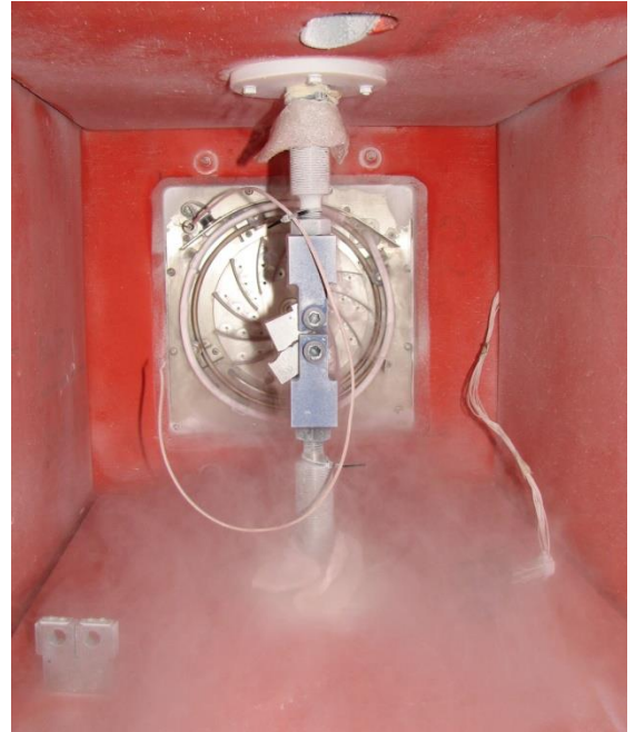
Bruchmechanikversuch: CT-Probe bei -140^{\circ}\text{C}
