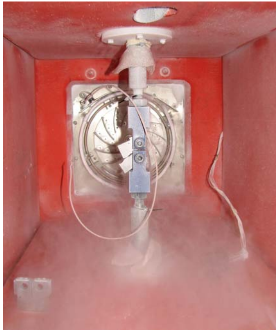
Bruchmechanikversuch: CT-Probe bei -140^{\circ}\text{C}
