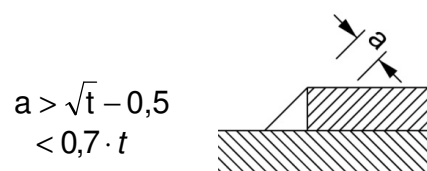
Bild 12: Nahtdickenbegrenzung nach DIN 18800
