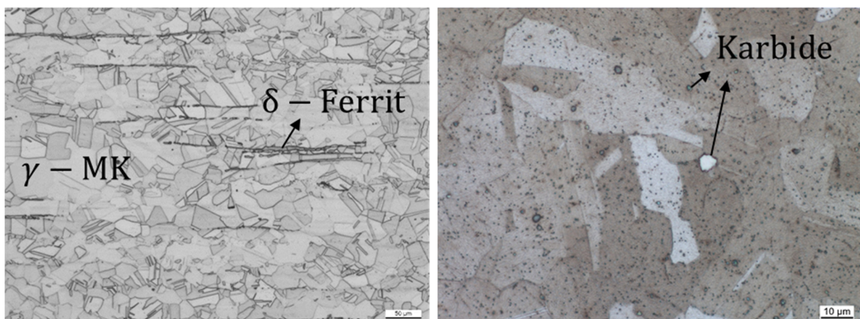
Abbildung 12: Gefügebild des austenitischen Grundwerkstoffs X6CrNiNb18-10
