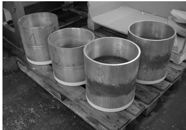
Abbildung 5: Versuchswerkstoff im Anlieferungszustand, Rohr 1 und 2 mit unbearbeitete Schweißnaht (wie geschweißt), Rohr 3 und 4 mit nachbearbeitete Schweißnaht (praxisnah beschliffen)
